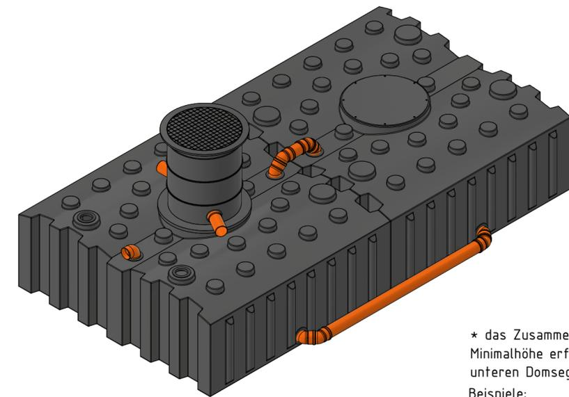
\* das Zusammenschieben des Doms auf Minimalhöhe erfordert das Ausschneiden des unteren Domsegments im Bereich der Rohre
