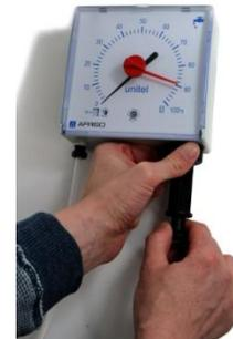
Mittels Pumpe unten rechts an der Anzeige mehrmals pumpen bis Luft im Erdtank aus dem Schlauch austritt.
