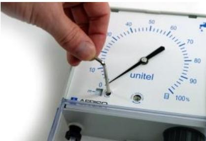
An der Anzeige die maximale Füllstandshöhe im Behälter einstellen. Siehe Tabelle für die AQa.Line Behälter.
