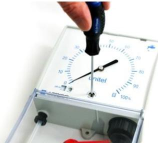
An der Anzeige den Zeiger mit der entsprechenden Schraube Nullen.
