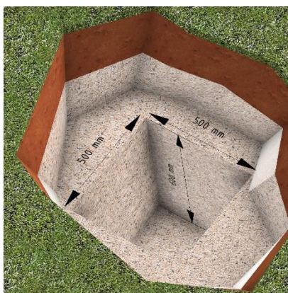
Anlegen der Schürfgrube (500 x 500 x 600 mm) idealerweise in der Tiefe, in der die Versickerung später erfolgen soll
